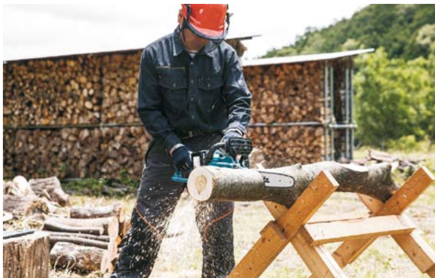
Zasady obsługi pilarki spalinowej: podczas pracy należy ją trzymać oburącz, ciąć na wysokości poniżej ramion, nie pozostawiać włączonej bez nadzoru i włączonego hamulca.
